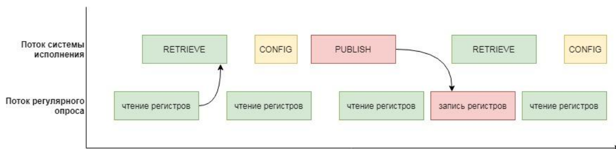
Рисунок 59 – Временная диаграмма чтения и записи Modbus
