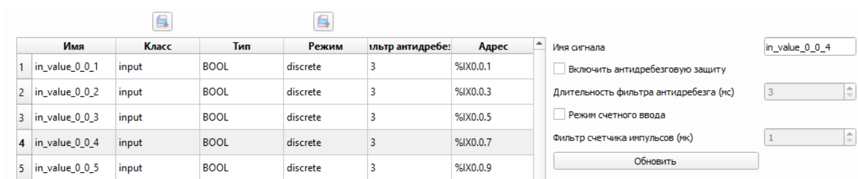
Рисунок 85 – Настройки каналов МДВ17
